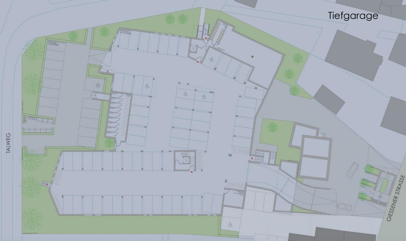
Die neuen Gebäude werden komplett durch die Tiefgarage unterbaut. In den Freiflächen und auf der Garagendecke werden weitere Stellplätze eingerichtet.
